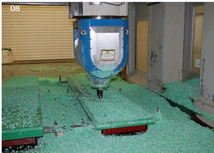
08 | Die zwei ersten Flügelformen beim sogenannten Schruppen 09 | Die Flügelwurzel nach dem Schlichten
