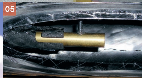
01 Das Kleinteileset für die Anlenkungen und der edle Wurfpin 02 Jeder Rumpf wird vor der Auslieferung mit 5 kg belastet 03+04 Wer einmal ein leichtes F3K-Wettkampfmodell ausprobiert und die Flugeigenschaften und -leistungen genossen hat, kommt nur schwer wieder davon los! 05 Der Ballast im Modell wird mit dem Querstift verriegelt. Eine weitere Sicherung gegen selbstständiges Verdrehen des Ballastes erfolgt beim Verschließen der Kabinenhaube
